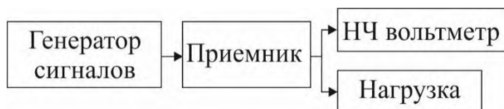
Рисунок 4 – Схема измерения номинальной чувствительности приемника.
