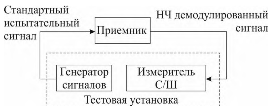
Рисунок 6 – Схема измерения номинальной чувствительности ПРМ в режиме телефонии с помощью специализированной тестовой установки.
